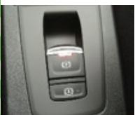
Le frein de parking agit en toute autonomie. Il se désactive au démarrage du véhicule, à la première accélération. Il peut être désactivé manuellement pour un démarrage moins brusque en actionnant le bouton prévu à cet effet.
